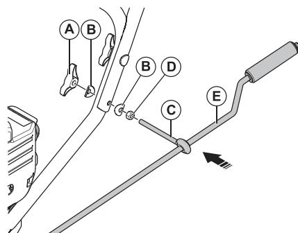
Присоедините рукоятку поворотного желоба к нижней ручке при помощи крепежа - бокс № 6: (A) барабанная гайка M8 – 1 шт.; (B) фигурная шайба – 2 шт.; (D) гайка M8 – 1 шт.
