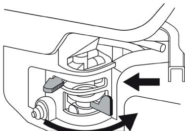
**Примечание!** Для повторного запуска горячего двигателя возможно оставить рычаг воздушной заслонки в положении «**ОТКРЫТО**».
