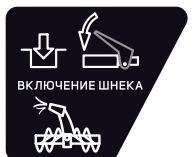
Нажмите на рычаг привода шнека по направлению к ручке управления, шнек начнет вращение и можно начинать расчистку снега. Для отключения шнека отпустите рычаг.
