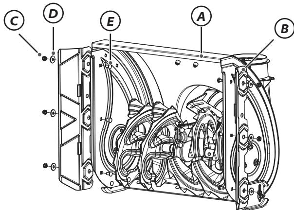
Система Original Extension System (XTS) позволяет увеличить ширину или высоту ковша, повысить производительность и возможность использования при очистке высоких сугробов. Установите пластину (B) на ковш (A) и закрепите. Для установки используйте крепежные элементы – бокс №10: (E) болт M8x20 – 6 шт.; (D) шайба – 6 шт.; (C) гайка M8-6 шт.
